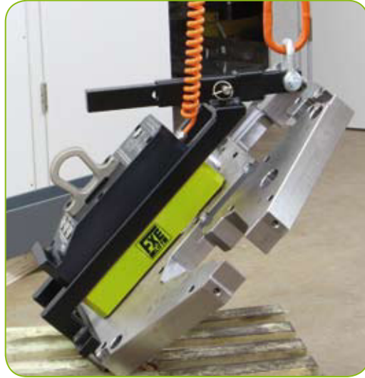
FXE HV-Vorrichtung zum horizontalen/vertikalen Heben
