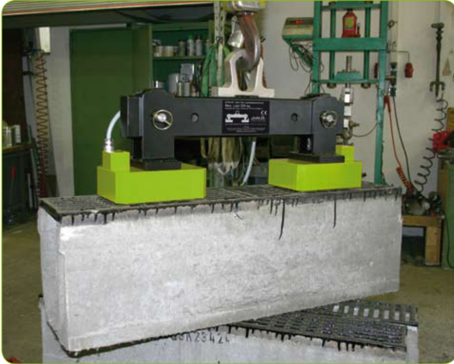
FXE-T Elektro-Permanent Tieffeldtraverse
