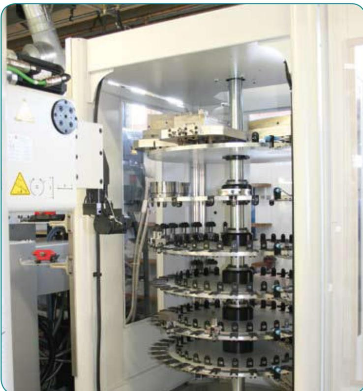
Magazin für Palettier-Magnetspannplatten und Werkzeuge
