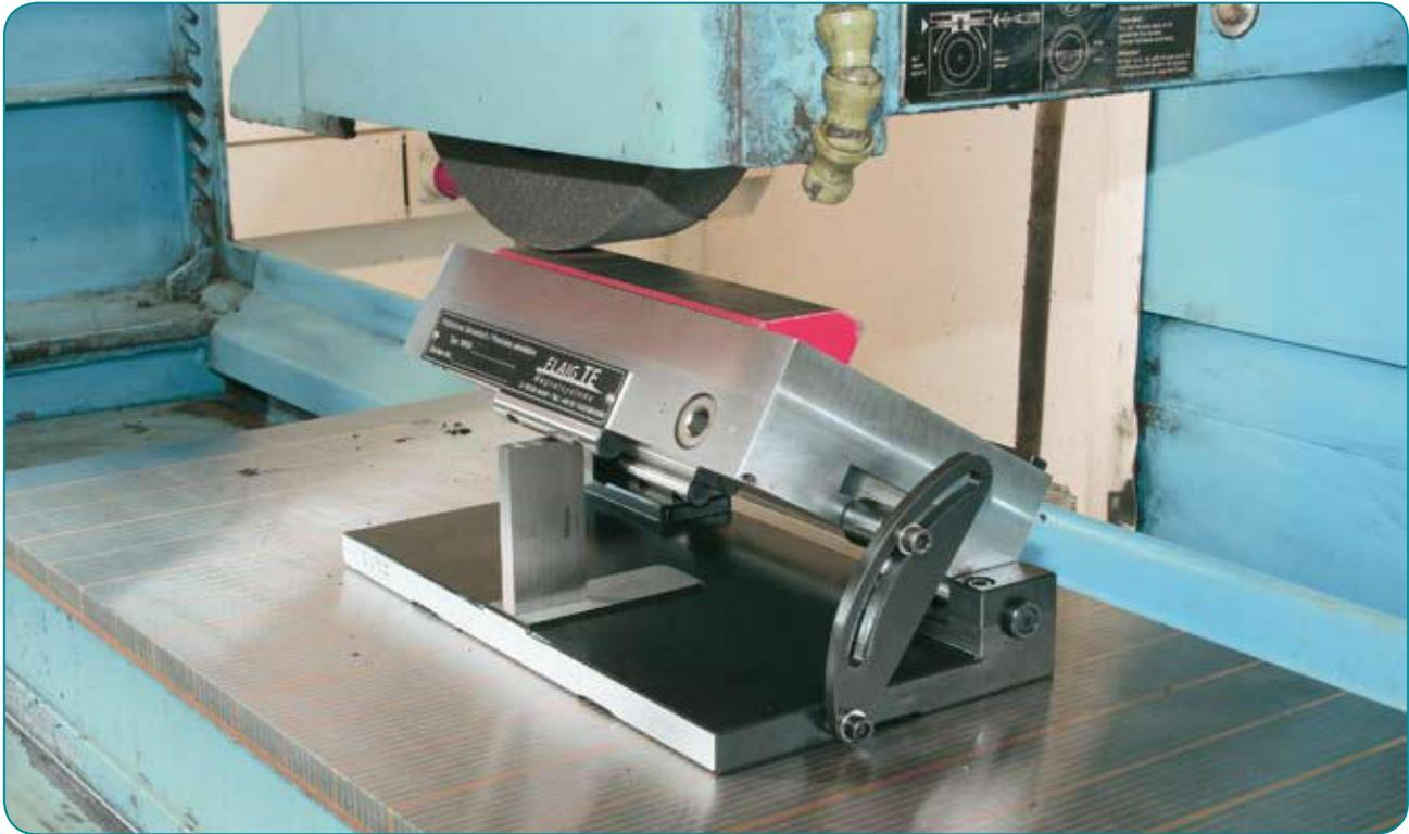
Wir bieten Ihnen ein große Bandbreite an Standardgeräten und fertigen auch gerne nach Ihren Vorgaben, in Präzision von 5 Sekunden, mit Permanent oder Elektro-Permanent Magnetspannplatten, zum Schleifen, Fräsen, Erodieren und Drahtschneiden.
