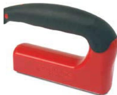
HM 3 Handmagnete mit gummierter Haftfläche sind bestens geeignet, um Bleche mit empfindlicher Oberfläche oder auch lackierte Teile zu handhaben. Auch sehr dünne Bleche haften an der mehrpoligen Magnetspannfläche sehr gut.
