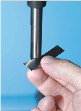
Abb. 4: Fühlerlehre darf NICHT in Verbindungslücke passen
