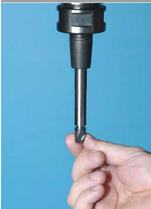
Abb. 4: Fühlerlehre darf NICHT in Verbindungslücke passen
