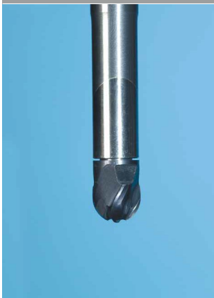
Abb. 2: Luftspalt in der Verbindungslücke
